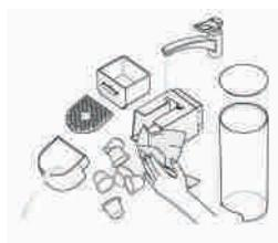
**① Codziennie opróżniać tackę ociekową,** podstawę ociekową i pojemnik na kapsułki. Wyjąć zbiornik na wodę wraz z pokrywą i oczyścić je za pomocą wilgotnej szmatki i bezzapachowego detergentu, a następnie przeplukać ciepłą lub gorącą wodą.
