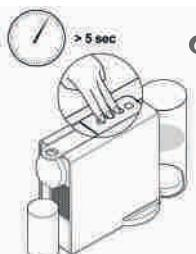
Για να μπείτε σε λειτουργία αφαίρεσης καθαλατώσεων: με ενεργοποιημένη τη μηχανή, πιέστε ταυτόχρονα τα κουμπιά Espresso, Lungo και ζεστό νερού επί 5 δευτερόλεπτα.
