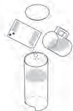
**4 Llena el depósito de agua** con agua fría potable hasta la mitad (aprox. 0,5 l). Vierte un sobre de líquido de descalcificación Nespresso en el depósito de agua.
