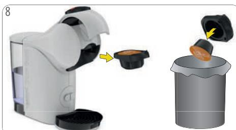
Vytiahnite držiak na kapsule. Odstráňte použitú kapsulu. Použité kapsule odhodte do odpadkového koša.
