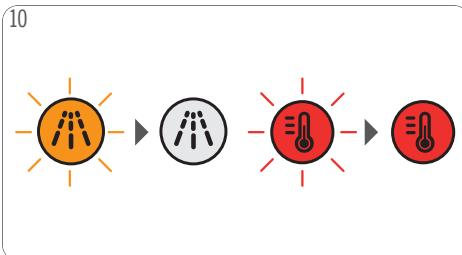
Indikátor odstraňovania vodného kameňa sa vypne, výber teploty bliká a keď začne svietiť načerveno, stroj je pripravený na použitie.
