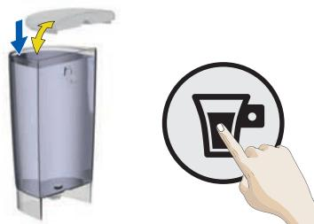
Skontrolujte, či sa v zásobníku na vodu nachádzá dostatočný čerstvý pitný voda. Ak nie, doplnite čerstvú pitnú vodu a pre pokračovanie prípravy stlačte tlačidlo spustiť/zastaviť. V prípade, že stále nevychádza žiadna kvapalina, pozrite si časť 10.3 „NEVYCHÁDZA ŽIADNA KVAPALINA – ZASEKNUTÁ KAPSÚLA?“.
