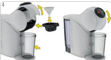
Otvorte poistnú rukoväť. Do držiaka na kapsule vložte nástroj na preplachovanie. Držiak na kapsule vložte do stroja. Zavorte poistnú rukoväť. Vyberte odkvapkávací podnos. Pod vývod kávy umiestnite prázdnu veľkú nádobu.
