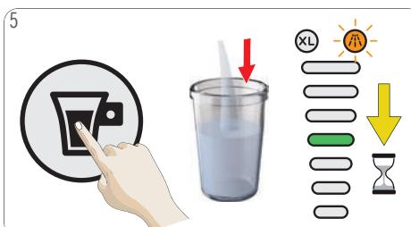
Sťačte tlačidlo spustiť/zastaviť. Stroj zaháji odstraňovanie vodného kameňa. Zobrazenie objemu sa zníži z najvyššej úrovne do 4. úrovne. Stroj bude odstraňovať vodný kameň s horúcou vodou systémom start-stop. Po vyprázdení zásobníka na vodu stroj zastaví odstraňovanie vodného kameňa.
