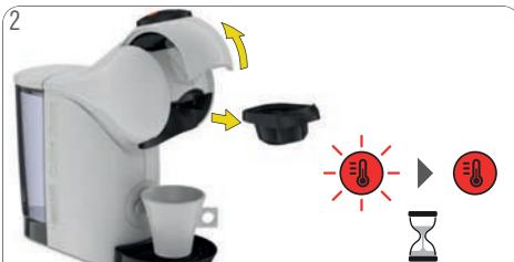
Otvorte poistnú rukoväť. Stroj sa automaticky vypne. Počas zohrevania stroja bude tlačidlo výberu teploty približne 40 sek. blikáť. Následne sa tlačidlo výberu teploty rozsvieti načerveno. Stroj je pripravený na použitie.
