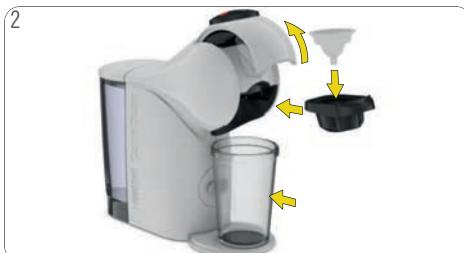
Otvorte poistnú rukoväť. Do držiaka na kapsule vložte nástroj na preplachovanie. Držiak na kapsule vložte do stroja. Pod vývod kávy umiestnite prázdnu veľkú nádobu.
