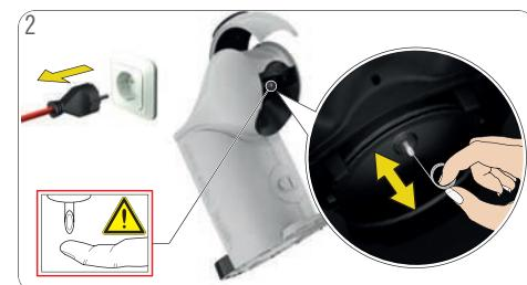
Vyberte držiač na kapsule. Otvorte pojistnú rukoväť. Vstrekovaciu trysku vyčistite pomocou ihly na čistenie. Postupujte podľa pokynov v 9. „Vodný kameň odstraňujte minimálne každé 3 – 4 mesiace“ na strane 16.
