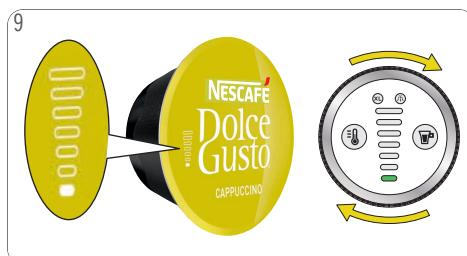
Pomocou ovládacieho krúžku nastavte objem podľa počtu paličiek, ktorý je zobrazený na kapsule, alebo vyberte požadovaný objem podľa vlastného výberu.
