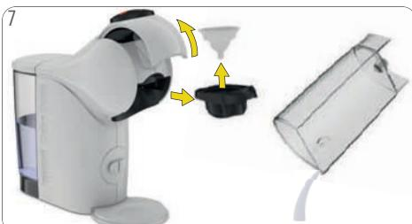
Otvorte poistnú rukoväť. Vytiahnite držiak na kapsule. Odstráňte nástroj na preplachovanie. Odložte na bezpečné miesto kvôli neskoršiemu vyčisteniu alebo odstráneniu vodného kameňa. Ak sa tam nachádza, odstráňte vodu zo zásobníka na vodu.
