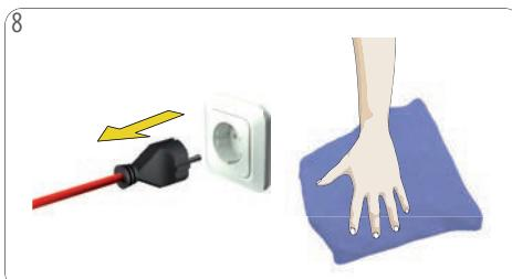
Vypnite zariadenie. Odpojte elektrickú zástrčku! Zariadenie vyčistite mäkkou, vlhkou látkou. Následne vysušte pomocou mäkkej, suchej látky.
