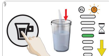
Stlačte tlačidlo spustiť/zastaviť. Stroj nepretržite preplachuje horúcou vodou. Zobrazenie objemu postupne klesá, až kým nezmizne. Po vyprázdení zásobníka na vodu stroj zastaví preplachovanie.
