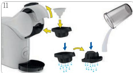
Odstráňte nádobu. Vyprázdnite a vyčistite zásobník. Vytiahnite držiak na kapsule. Odstráňte nástroj na preplachovanie. Odložte na bezpečné miesto kvôli neskoršiemu vyčisteniu alebo odstráneniu vodného kameňa. Obidve strany držiaka na kapsule prepláchnite čerstvou pitnou vodou. Znovu vložte držiak na kapsule.
