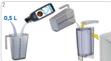
Ak sa tam nachádza, odstráňte vodu zo zásobníka na vodu. V odmerke zmiestajte 0,5 liter čerstvej pitnej vody s odstraňovačom vodného kameňa. Roztok na odstránenie vodného kameňa vlejte do zásobníka na vodu a zásobník na vodu vložte do stroja.
