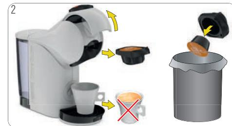
Kávu nepite! Otvorte pojistnú rukoväť. Stroj uvoľňuje tlak. Vyberte držiač na kapsule. Použité kapsule odhodte do odpadkového koša.
