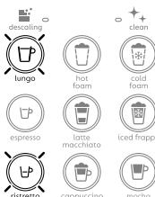
⑧ Wanneer de ontkalkingscyclus is voltooid (het waterreservoir is leeg), knipperen de Lungo en Ristretto toetsen.
