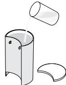
❾ Spülen Sie den Wassertank und füllen Sie ihn vollständig mit frischem Trinkwasser.
