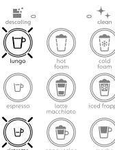
**8** Nach Abschluss des Entkalkungsvorgangs (der Wassertank ist leer) blinken die Tasten „Lungo“ + „Ristretto“.
