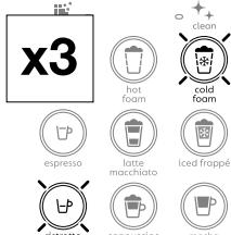
**6** После завершения опорожнения обе кнопки мигнут 3 раза, после чего устройство автоматически выключится.
