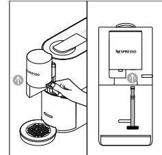
**⚠️** Wacht tot aan het einde van de bereiding en tot het „Reinigen“ controlelampje brandt voordat u de melkopschuimer aanraakt.
