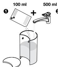
③ Vacíe la bandeja de goteo, la base de goteo y el recipiente de cápsulas. Rellene el depósito de agua con 500 ml de agua potable fresca. Vierta 1 sobre de líquido descalcificador *Nespresso* en el depósito de agua.
