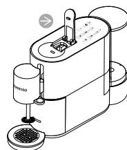
② Levante la palanca y ciérrela de nuevo para extraer la cápsula.
