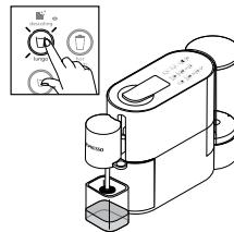
⑬ Нажмите кнопку Lungo для промывки устройства. Повторите эту процедуру три раза. Нажмите кнопку Hot Foam для очистки паровой системы. Устройство готово к использованию.
