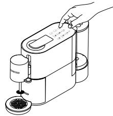
**1** Вставьте вспениватель. Включите устройство, удерживая одну из 9 кнопок в течение 1 секунды.
