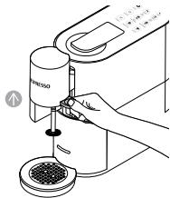
**4** Setzen Sie den Milchaufschäumer ein.
