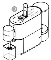
⑨ Поднимите рычаг и оставьте его в открытом положении.
