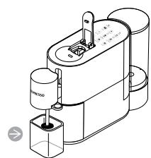
**2** Verwijder het waterreservoir. Breng de hendel omhoog om de capsule te verwijderen. Laat de hendel open. Plaats een bak (600 ml) onder de kop.
