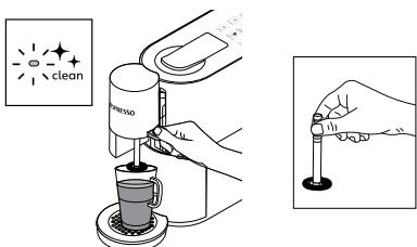
⚠ Перед тем как извлекать вспениватель, дождитесь, пока закончится приготовление и загорится индикатор Clean (Очистка). Важно брать вспениватель за предназначенную для этого область, так как он может быть горячим после завершения приготовления.
